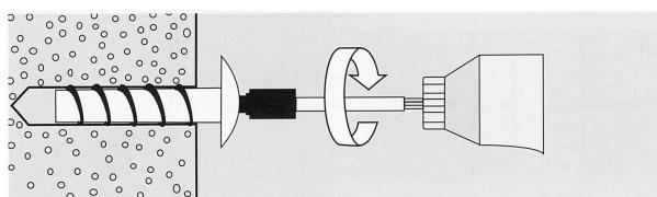
Dübel mit Eindrehadapter und Schraubwerkzeug eindrehen.
