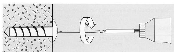
Anker mit Adapter in den gesetzten Dübel einschrauben.
