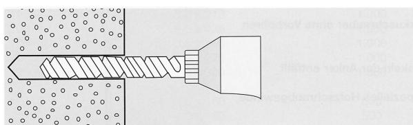
Mit Stahlbohrer 10 mm Ø Loch bohren.
