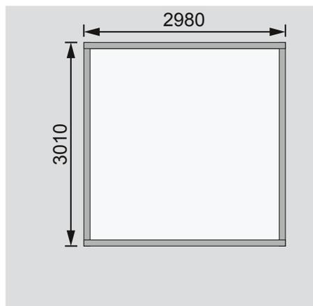
**Fundamentplan mit Boden (in mm)**
