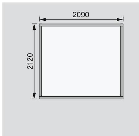
**Fundamentplan mit Boden (in mm)**
