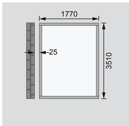
**Fundamentplan mit Boden (in mm)**
