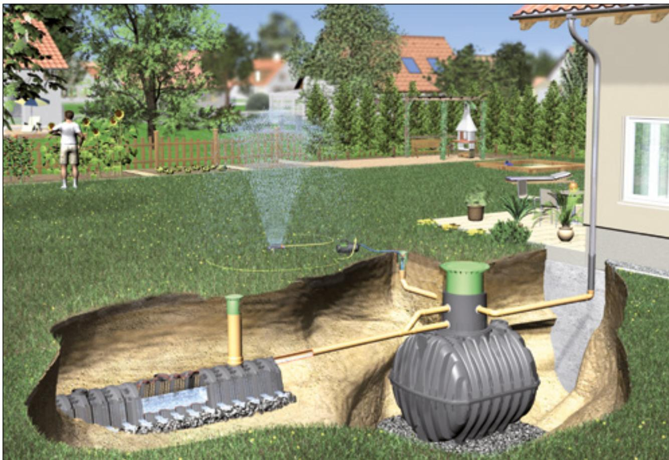
Der GRAF Sicker-Tunnel ist vor allem für die Anwendung im privaten und ländlichen Bereich konzipiert. Das System, bestehend aus einem oder mehreren Tunnel-Modulen sowie zwei Endplatten, lässt sich beliebig erweitern. Die Verlegung erfolgt in einer Ebene.
