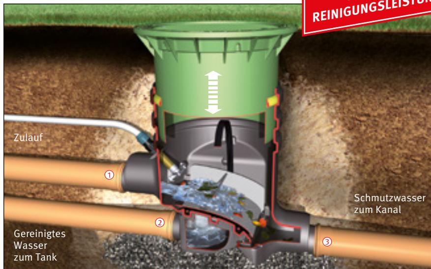
Filtereinsatz mit extrem glatter Oberfläche, dadurch max. Selbstreinigung, Maschenweite 0,35 mm.
