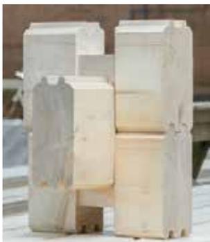
Wandbohlen mit spezieller Eckverbindung (Chalotschnitt) für winddichte Wandecken. Doppelnut schon ab 34 mm Wandstärke gewährleistet ein wärmeres Haus.
