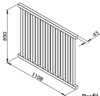
Mit Dübel und wasserdichtem Leim verbunden.
