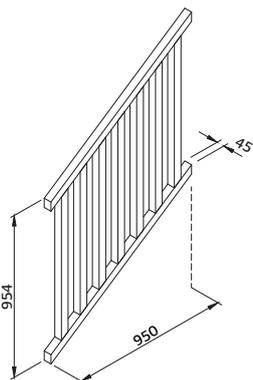
Mit Dübel und wasserdichtem Leim verbunden.
