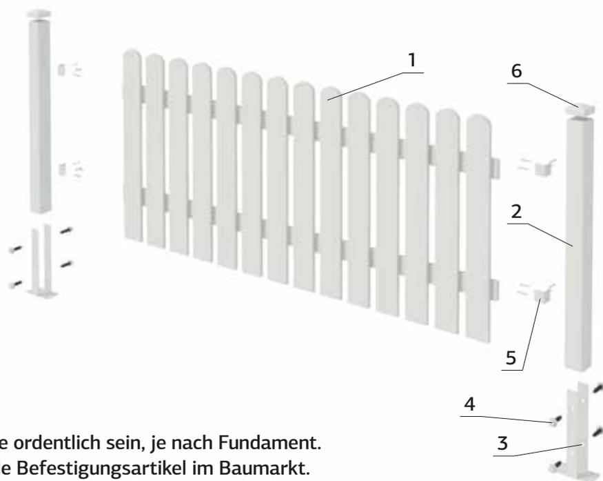
Die Befestigung am Boden sollte ordentlich sein, je nach Fundament. Besorgen Sie sich entsprechende Befestigungsartikel im Baumarkt.
