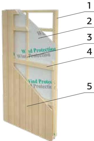
Die Gesamtelementstärke der Nordic+ Häuser beträgt 160 mm. Hier sehen Sie den Querschnitt eines Elements, sodass Sie besser erkennen können, wie diese Elemente aussehen und woraus sie bestehen:
