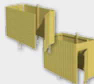
Seiten- und Rückwände aus Deckelschalung
