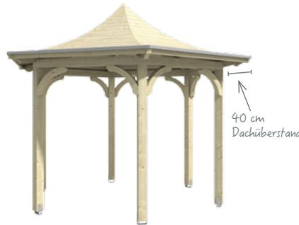
Hochwertiger **6-Eck-Pavillon VERSAILLES** aus Leimholz (BSH-Fichte), Pfosten 12 x 12 cm inkl. Aufschraubstützen. Umlauender Dachüberstand 40 cm. Der Pavillon verfügt über eine geschwungene Dachkonstruktion. Das Montagematerial ist im Lieferumfang enthalten.
