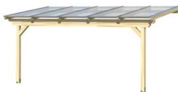
Die hochwertige **Terrassenüberdachung ANCONA** ist aus Leimholz (BSH Fichte) gefertigt. Stabile Doppelpfetten-Konstruktion **ohne Mittelpfosten** und geraden Kopfbändern. **Pfosten 12 x 12 cm inkl. Aufschraubstützen. Dacheindeckung aus 16 mm Polycarbonat Doppelstegplatten in klar.**
