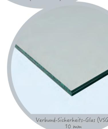
VSG: Verbund aus 2 Flachglasscheiben verklebt mit einer hochstabilen Folie. Splitterschutz und bessere Schalldämmung gegenüber einfacher Verglasung. Kondenswasserbildung bei Temperaturschwankungen möglich. Sehr hohe Formstabilität bei hohen Oberflächentemperaturen. Optimale Lösung für ungehinderten Lichteinfall mit minimalem Lichtverlust.
