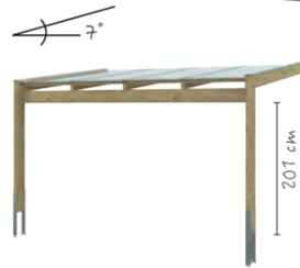
Die hochwertige **Terrassenüberdachung NOVARA** ist aus Leimholz (BSH-Fichte) gefertigt. Massive Konstruktion **ohne Mittelpfosten und Kopfbändern**.
