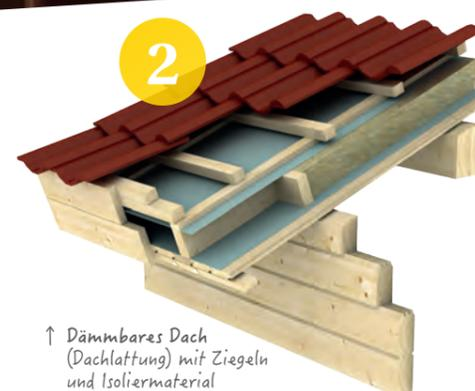
↑ Dämmbares Dach (Dachlattung) mit Ziegeln und Isoliermaterial
