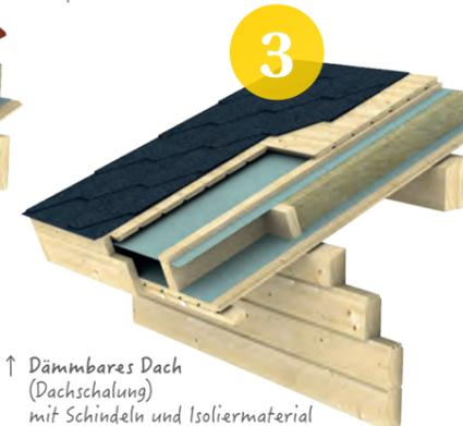
↑ Dämmbares Dach (Dachschalung) mit Schindeln und Isoliermaterial
