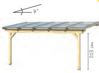
Die hochwertige **Terrassenüberdachung ANCONA** ist aus Leimholz (BSH Fichte) gefertigt. Stabile Doppelpfetten-Konstruktion **ohne Mittelpfosten** und geraden Kopfbändern. **Pfosten 12 x 12 cm inkl. Aufschraubstützen. Dacheindeckung aus 16 mm Polycarbonat Doppelstegplatten in klar.**
