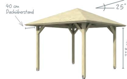
Die Konstruktion ist aus Leimholz gefertigt. Dieses besteht aus mehreren getrockneten, der Länge nach durch Keilzinkung verbundenen Lagen. Diese werden übereinander wetterfest verleimt. So entsteht ein tragfähiger Balken der gegenüber natürlich gewachsenem Holz verwindungsärmer ist und weniger zur Rissbildung neigt.
