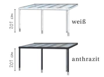
Die hochwertigen **Terrassenüberdachungen** **GARDA** und **MONZA** aus Aluminium, pulverbeschichtet in weiß (RAL 9016) und anthrazit (DB0703 Struktur), verfügen über **11 x 11 cm starke Pfosten**, die vorne abgerundet sind. **Die Dacheindeckung besteht wahlweise aus 16 mm starken Doppelstegplatten oder aus 10 mm Verbundsicherheitsglas.**
