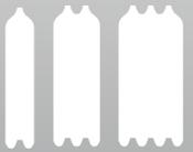
Alle Blockbohlen haben eine Nut- und Federfräsung. Die 28 mm-Bohlen eine Einfachnut, die 45 mm-Bohlen eine Doppelnut und die 70 mm-Bohlen eine Dreifachnut.
