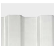
Dachplatten mit Trapezprofil in zwei modellabhängigen Ausführungen: Aluminium, unbehandelt (blank) oder Aluminium, farbbeschichtet (Oberseite anthrazit/Unterseite lichtgrau). Bruchsicher und hagelbeständig. Sehr hohe Geräusentwicklung bei Niederschlag. Kondensbildung bei Temperaturschwankungen möglich. Hohe Formstabilität bei hohen Oberflächentemperaturen.
