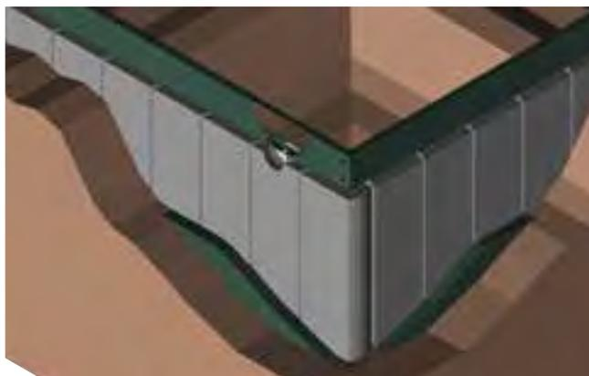
Streifenfundament aus Betonstein
