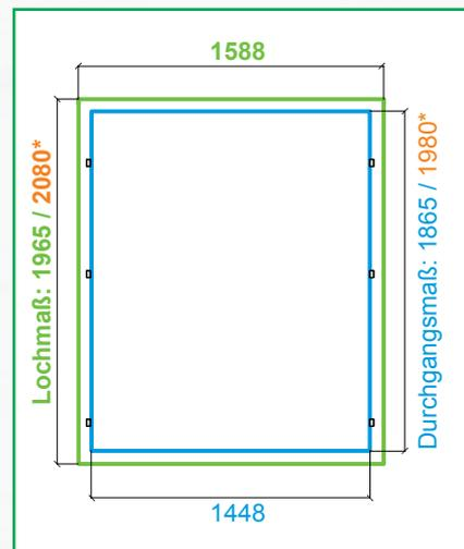
Beim Einbau seitlich auf das Lochmaß 10 mm und nach oben 30 mm addieren.
