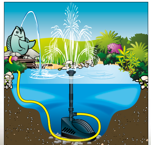
Powerclear mit Fontäne in Kombination mit einem Wasserspeicher
