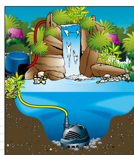
BioPressure mit Elimax speist Bachlauf
