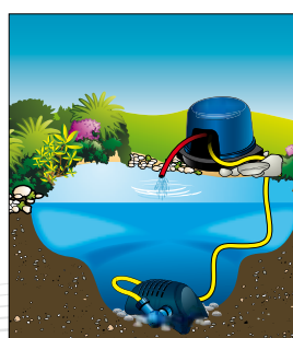
BioPressure, eingegraben, mit Powermax Pumpe
