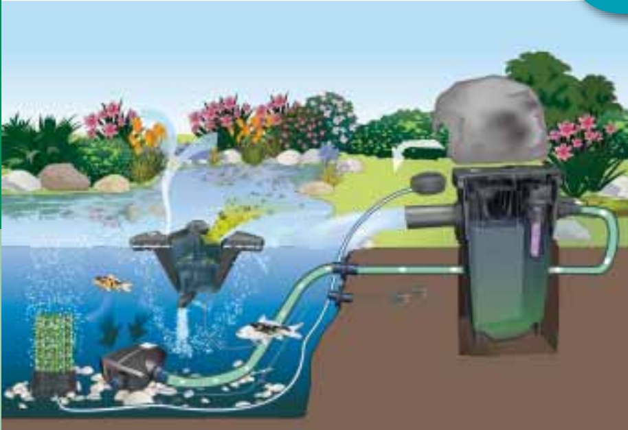
Schematische Darstellung: Zusammenspiel der Funktionen im Clear Water System
