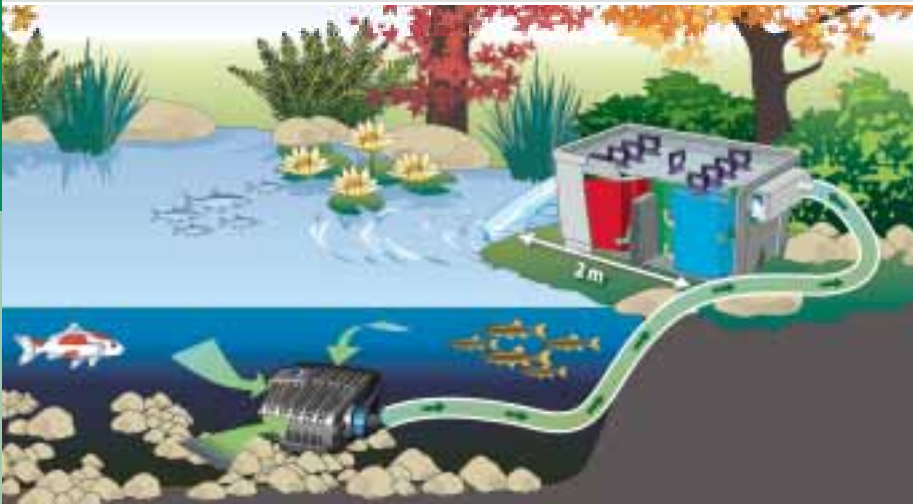
Schematische Darstellung: BioSmart 36000 in Kombination mit Filter- und Bachlaufpumpe AquaMax Eco Classic
