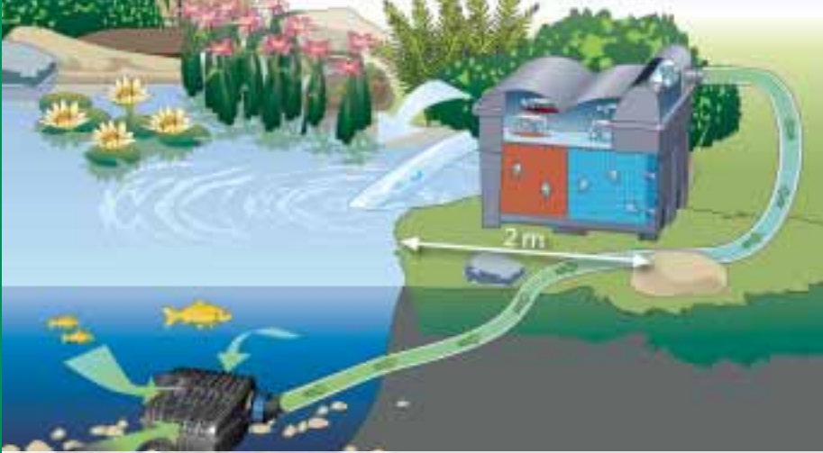
Schematische Darstellung: BioSmart UVC 16000 in Kombination mit Filter- und Bachlaufpumpe AquaMax Eco Classic
