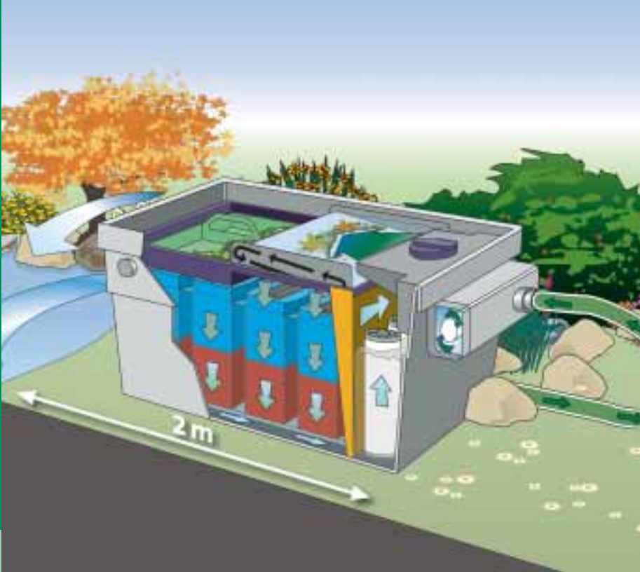
Schematische Darstellung: UVC-Vorklärgeräte in Kombination mit OASE-Durchlauffilter BioTec ScreenMatic
