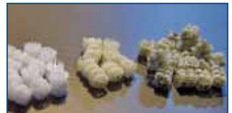
Biologische Oberfläche zur Ansiedlung der Mikroorganismen (links noch unbenutzte Biomedien, rechts mit angesiedelten Mikroorganismen).
