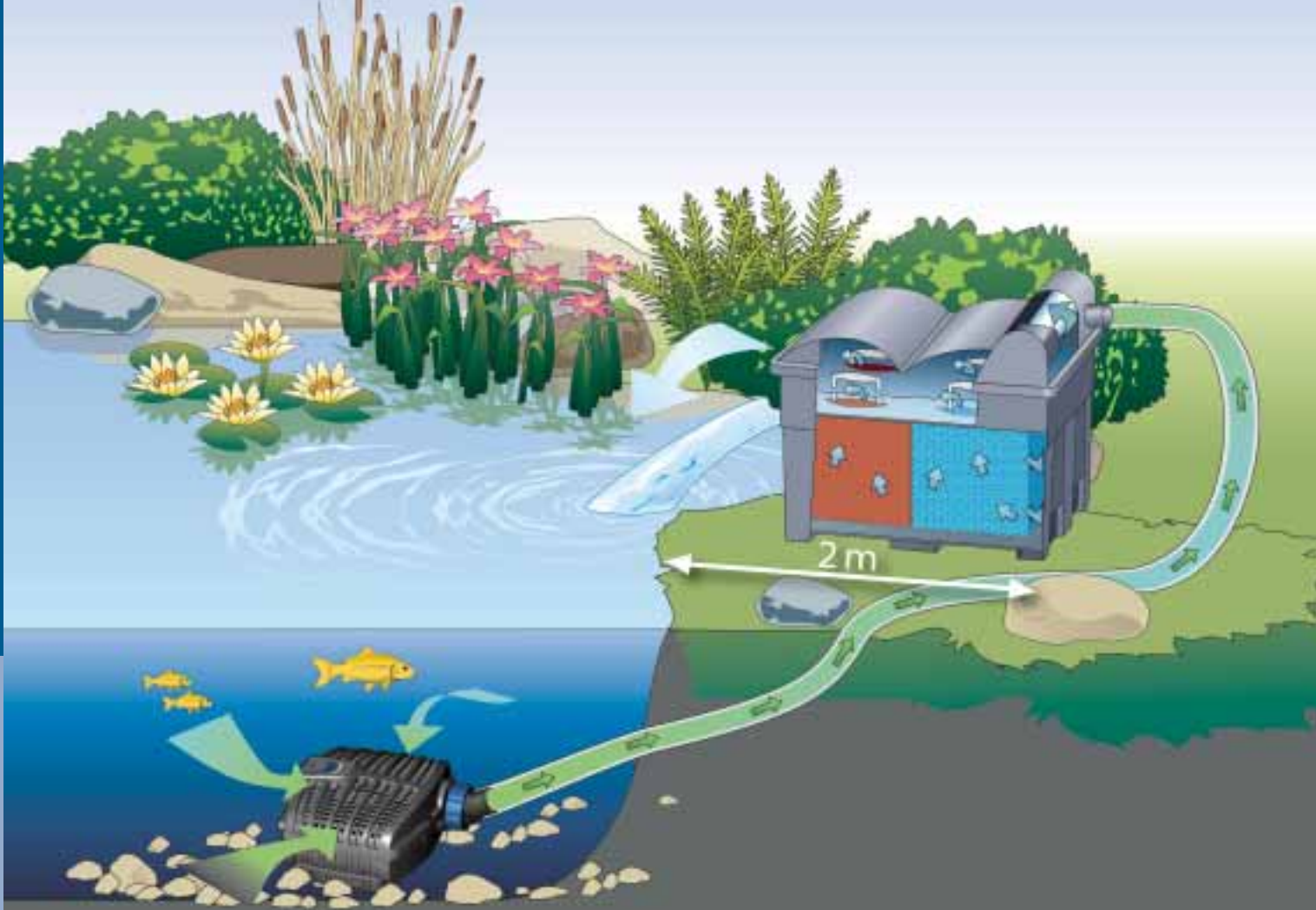
Schematische Darstellung: Filter- und Bachlaufpumpe AquaMax Eco Classic (START) in Kombination mit einem OASE-Durchlauffilter BioSmart (START)
