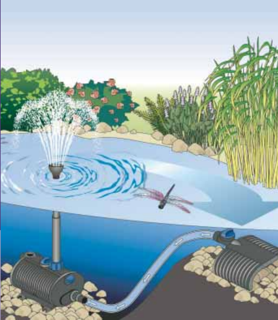
Schematische Darstellung: Aquarius Fountain Set in der Anwendung
