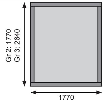
Fundamentplan (in mm) bei Aufbau mit Fußboden:
