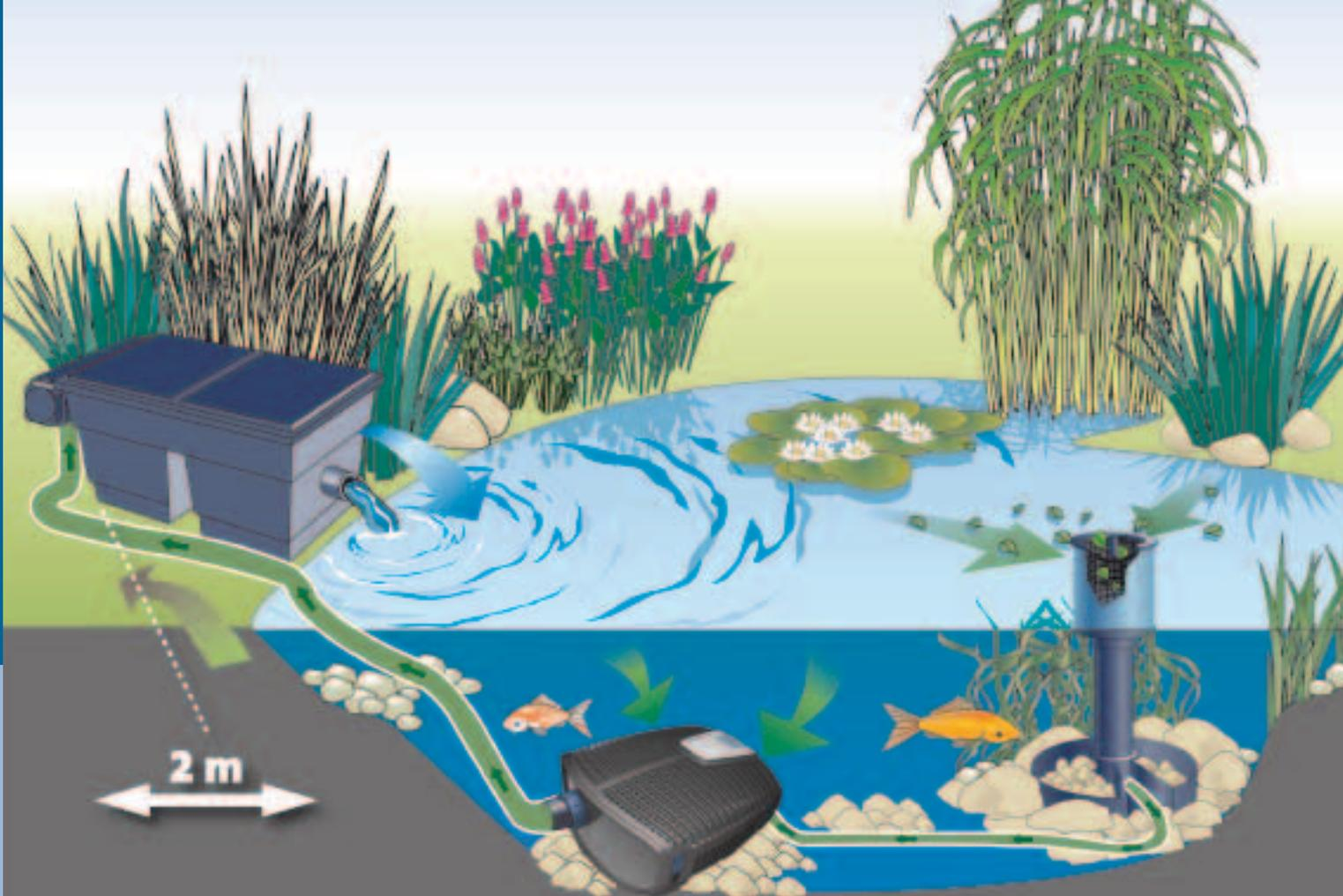
Schematische Darstellung: Filter- und Bachlaufpumpe AquaMax Eco Twin in Kombination mit OASE-Durchlaufpumpe und zusätzlich angeschlossener OASE-Skimmer AquaSkim 40
