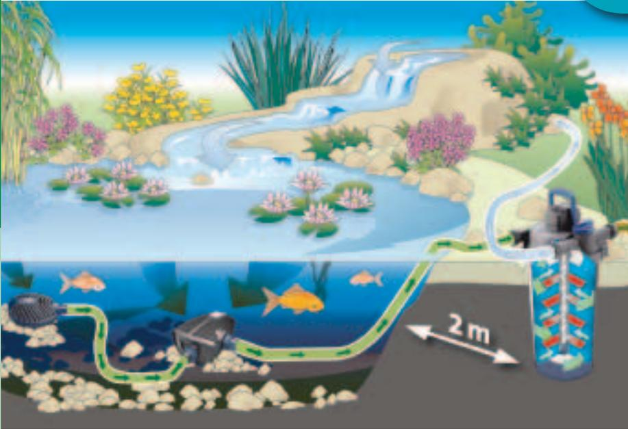
Schematische Darstellung: Druckfilter FiltoClear in Kombination mit Filter- und Bachlaufpumpe
