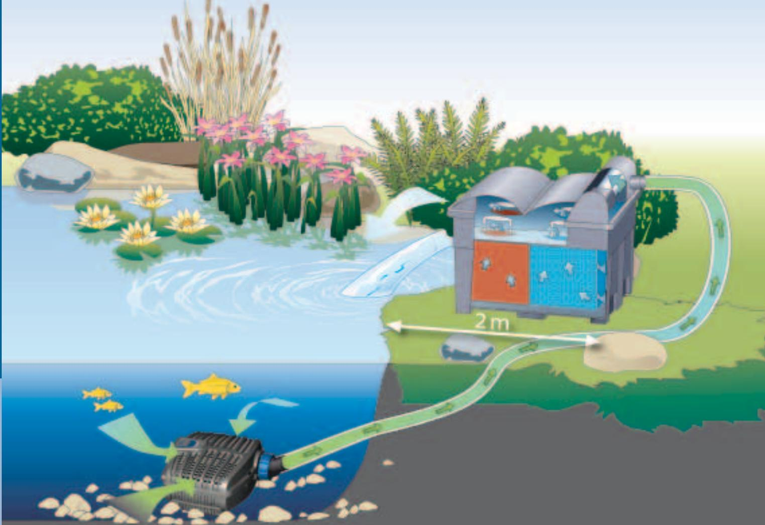
Schematische Darstellung: Filter- und Bachlaufpumpe AquaMax Eco Classic (START) in Kombination mit einem OASE-Durchlauffilter BioSmart (START)
