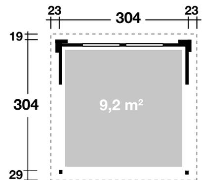
Grundriss: Komplettsset: Wände mit 2 Fenster
