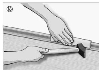
Nach der Verlegung werden die Abstandskeile entfernt und die Sockelleisten (mit und ohne Clip-System montierbar) an der Wand befestigt – fertig.
