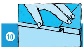
Übergänge zwischen dem **antigua HYDROTEC-Fertigfußboden** und anderen Bodenbelägen sowie zwei aneinanderliegenden Räumen müssen generell mit einem Parkettprofilssystem abgedeckt werden.
