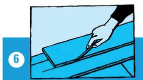
Die letzte Dielenreihe wird in die richtige Breite gesägt. Dabei ist auf die Dehnungsfuge zu achten! Danach wird die Dehnungsfuge mit einer Fußleiste abgedeckt. Sie darf allerdings nicht zu dicht auf dem **antigua HYDROTEC-Fertigfußboden** liegen, um die Bewegungsfreiheit des Bodens nicht zu beeinträchtigen.
